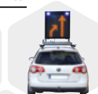
Rétrécissement de deux à une voie
